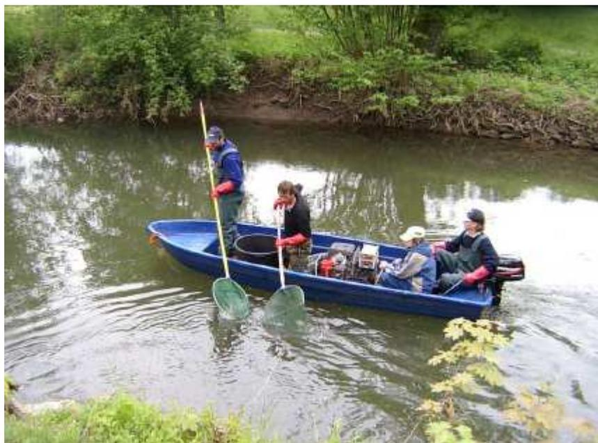
Abb. 3: Bootbefischung mit Elektrofischereigerät FEG 11000
